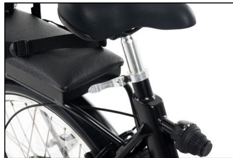
Ouvrir le blocage rapide pour régler la selle
