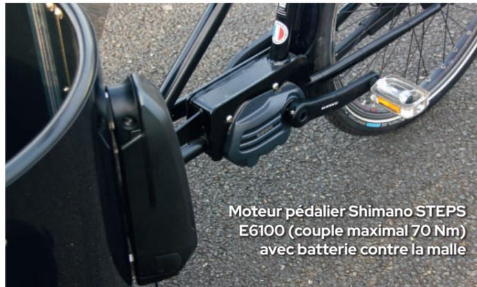
Moteur pédalier Shimano STEPS E6100 (couple maximal 70 Nm) avec batterie contre la malle
