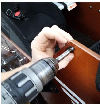
Placez le transparent sur les fixations hautes afin de déterminer l'inclinaison. Retirez-le et visser les secondes vis.
