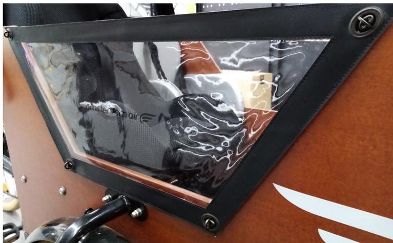
Placez une dernière fois le transparent sur les fixations hautes et basses de façon à déterminer la position définitive des fixations basses. Retirez-le et vissez les 2 dernières vis.
