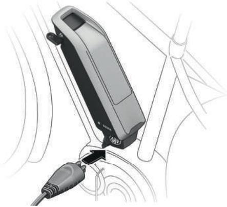
Image 31 : Branchement du chargeur dans la prise de charge sur la partie inférieure du support de batterie
