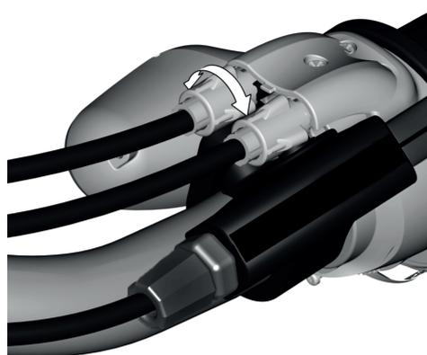
Image 42 : Réduire ou augmenter le jeu du câble en tournant le cylindre sur la poignée de changement de vitesses
