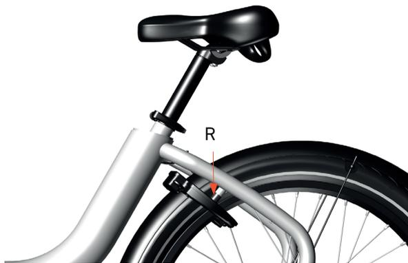
Image 39 : Vérification des caoutchoucs de verrouillage
