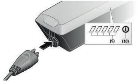
Image 32 : Brancher le connecteur de charge dans la prise de charge de la batterie
