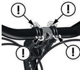
Image 9B : Tourner les boulons d'angle du guidon
